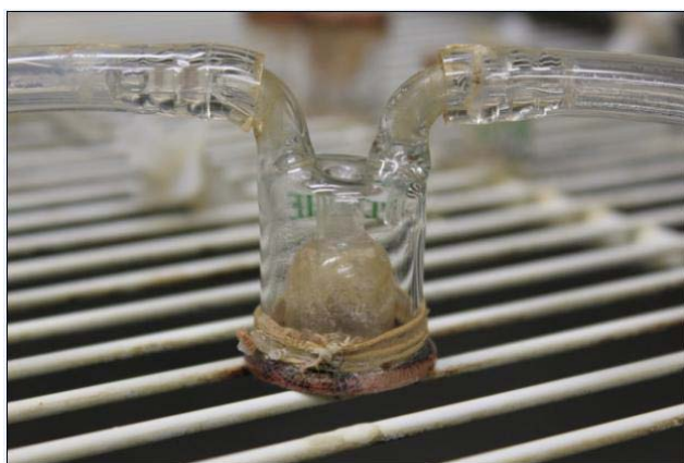
圖 1.飼養庫蠓所用的玻璃製餵血器（blood-feeding apparatus），使用絲襪和矽膠製作的人工薄膜模擬庫蠓自動物皮膚吸血的環境。
