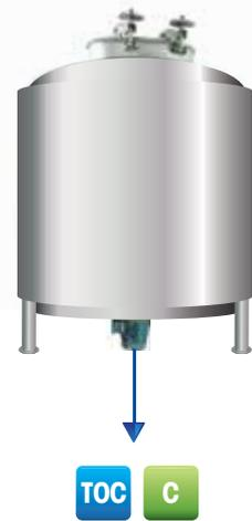
CIP 最終沖洗的測試容器
