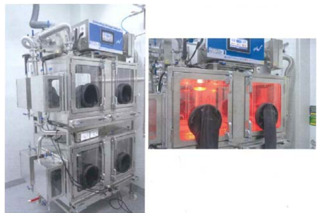
圖二、家禽與鴨專用之生物安全等級三級隔離飼養籠。
